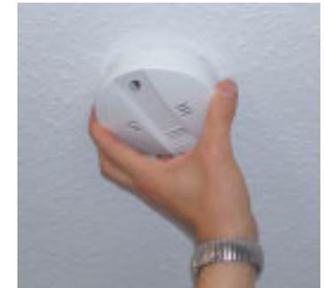
Rauchmelder sind ungefähr handgroße Geräte, die problemlos montiert werden können. Die meisten arbeiten nach dem Streulichtprinzip. Bei einer bestimmten Rauchdichte wird ein Lichtstrahl im Gerät auf eine Fozelle gelenkt und löst den akustischen Alarm aus. Für Gehörlose gibt es die Möglichkeit der Warnung durch ein Blitzlicht und Vibrationsgeber.
